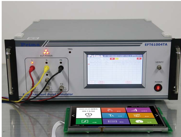
图 3-4 群脉冲测试图
