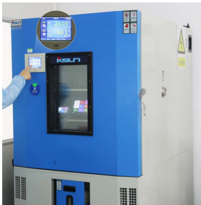
图 3-3 高低温老化测试图
